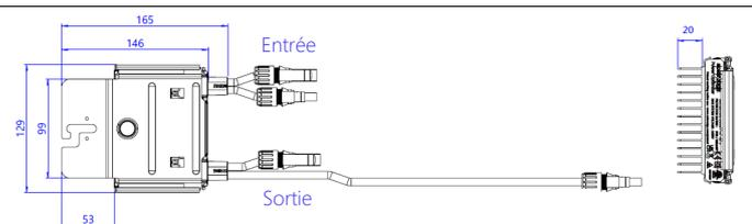
Schéma mécanique S1200
