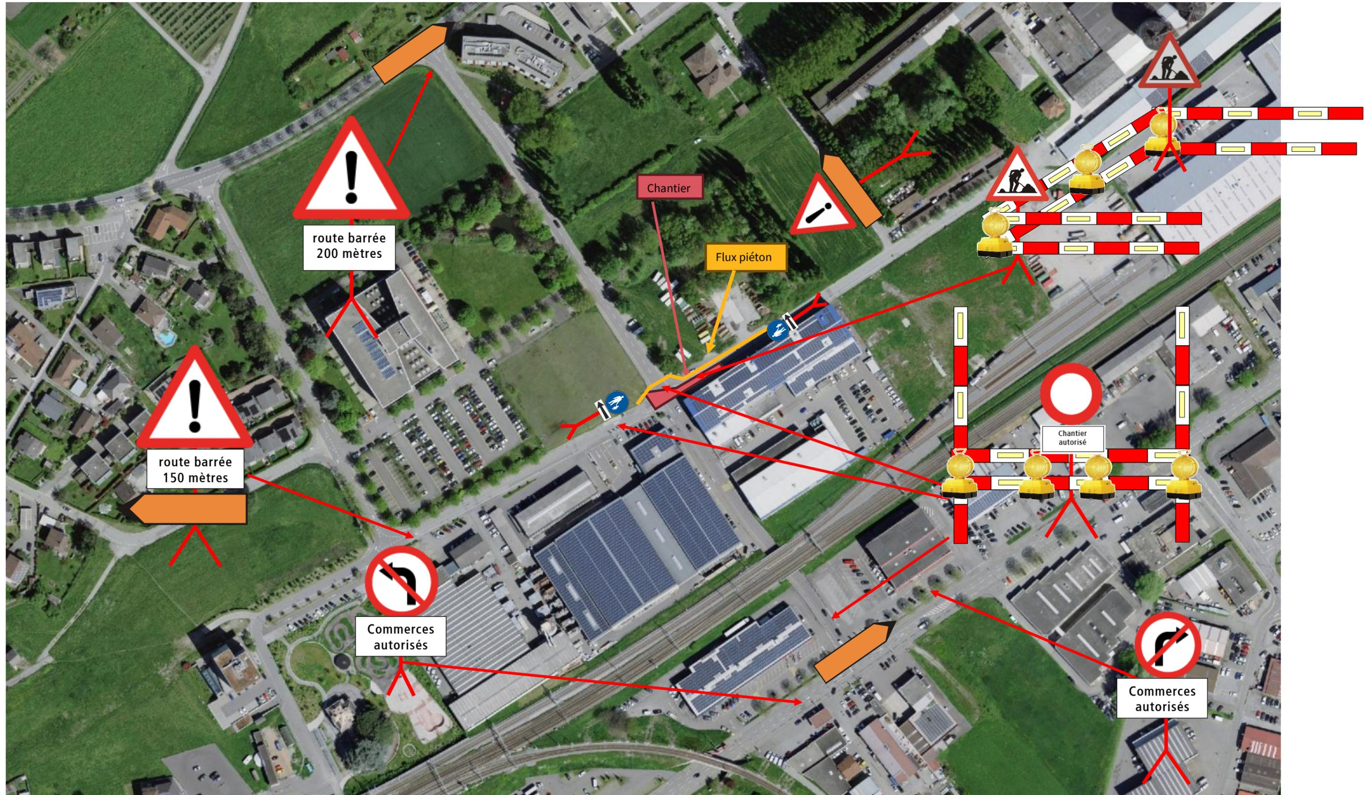
Ce schéma n'est qu'une illustration de la signalisation mise en place. Le respect de la norme VSS 40886 doit être garanti pour tous les éléments nécessaires à la sécurisation et ne figurant pas sur ce schéma.
