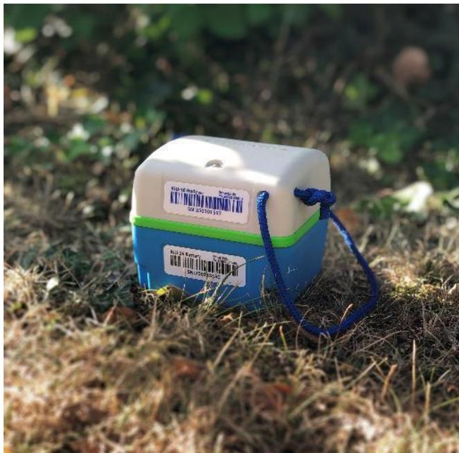
*Capteur SmartSolo IGU-16 5Hz*
